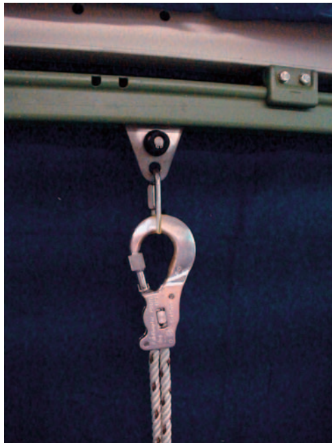
Bild 15: Anschlagereinrichtung mit horizontaler Führungsschiene und beweglichem Anschlagpunkt
