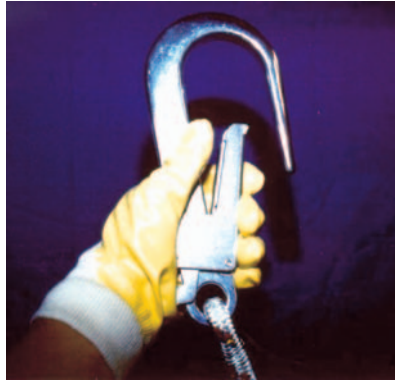
Bild 9: Karabinerhaken mit großer Öffnungsweite (Rohrhaken)
