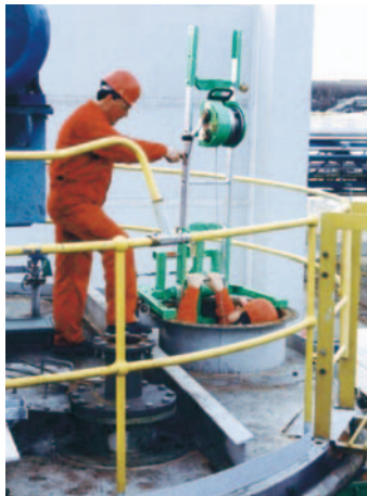
Bild 5: Rettungshubgerät der Klasse B
